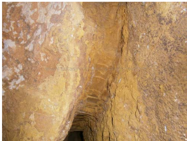
Veta de ocre y señales de picoletas en la mina El Sabinar
